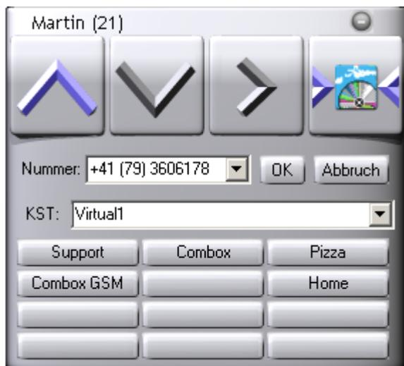
Unter KST kann nun eingestellt werden, welcher CLIP signalisiert werden soll.
